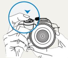
Verwenden Sie bitte die Funktion 'halb-gedrückt', um sich vorab zu vergewissern, ob die richtige Schärfe eingestellt worden ist. Wenn Sie den Auslöser halb drücken, werden die Schärfe und die Belichtung automatisch angepasst.
