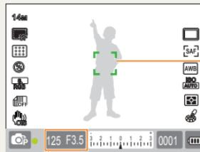
Отображение установленных данных выдержки и диафрагмы
