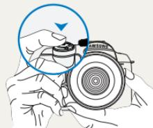
Чтобы убедиться в том, что фокус настроен правильно, слегка нажмите на кнопку спуска затвора. При неполном нажатии кнопки спуска затвора, фокусировка и экспозиция будут настроены автоматически.
