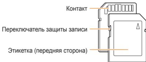
Можно предотвратить удаление файлов с помощью переключателя защиты на карте SD или SDHC. Переместите переключатель вниз, чтобы установить защиту карты, или вверх, чтобы снять защиту. Снимите защиту карты во время съемки.
