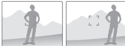
Nello stato di pressione parziale dell'otturatore premere il tasto **[AEL]** della fotocamera per fissare il valore dell'esposizione e le informazioni sulla messa a fuoco in base all'impostazione. Per disattivare la funzione, premere ancora una volta il tasto **[AEL]**. (Manuale dell'utente su CD-ROM, pagina 77)
