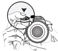
Per controllare in anticipo se la messa a fuoco della scena è impostata correttamente, utilizzare la pressione parziale dell'otturatore. Se si preme parzialmente l'otturatore, la messa a fuoco e l'esposizione verranno regolate automaticamente.
