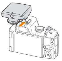
3 將熱靴固定撥盤旋轉到 LOCK,將 GPS 模組鎖定就位。
