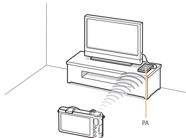
▲ A câmera está conectada a uma TV compatível com Samsung Link através de WLAN.
