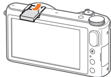
2 Conecte o módulo GPS, deslizando-o no suporte.
