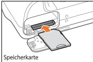
Setzen Sie die Speicherkarte mit den goldfarbenen Kontakten nach untenweisend ein.
