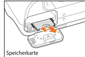
Drücken Sie vorsichtig gegen die Speicherkarte, bis sie ausgeworfen wird, und ziehen Sie sie dann aus dem Einschub.
