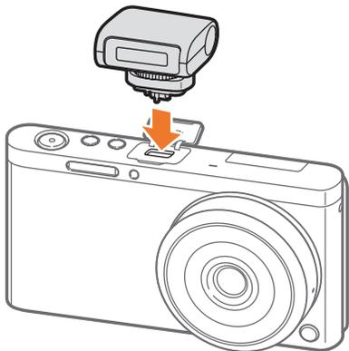
3 如圖所示轉動閃光燈固定撥盤，將閃光燈鎖定到位。
