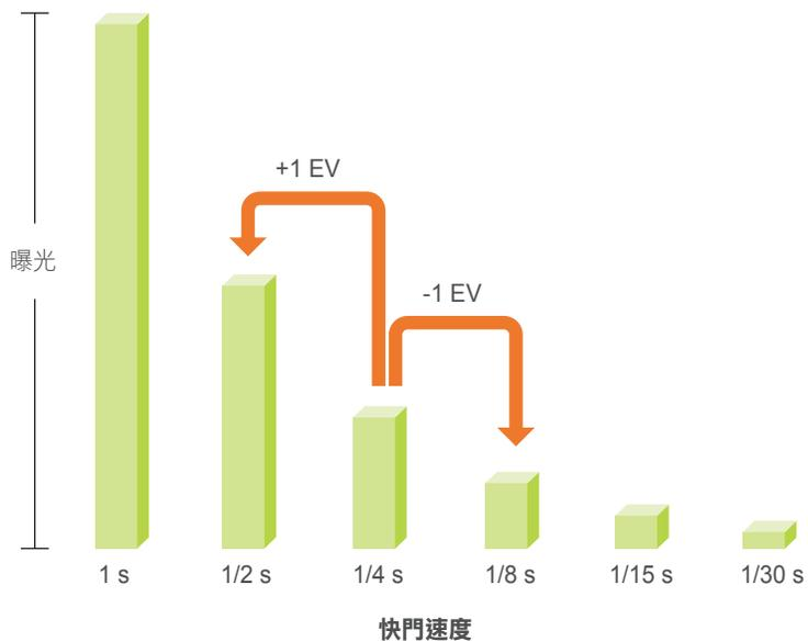
因此，快門速度越快，進入的光線越少。同理，快門速度越慢，進入的光線越多。
